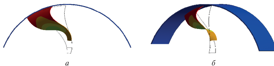
Рис. 6. Деформированная форма лопатки вентилятора АГТД при обжатии на неподвижный абсолютно жесткий корпус: a — вид спереди; б — вид в изометрии
