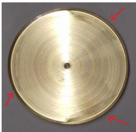
Рис. 8. Деталь с необработанными зонами между переходами
