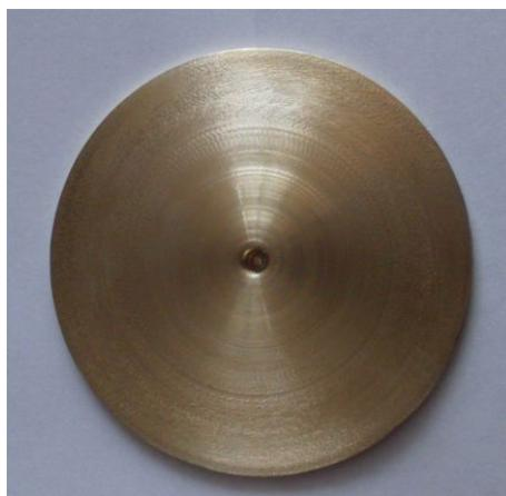
Рис. 9. Дисковая заготовка для облицовки компактного летательного аппарата после обработки
