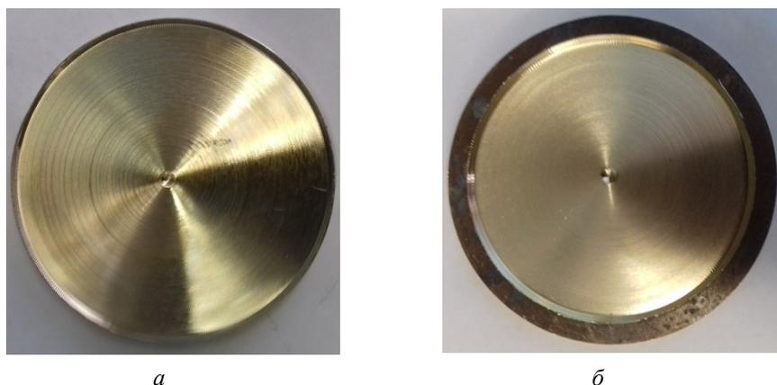
Рис. 3. Заготовки с узким (а) и широким (б) технологическим буртом
