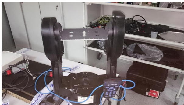
Рис. 10. Поворотный стол на основе Meade LX90-ACF
