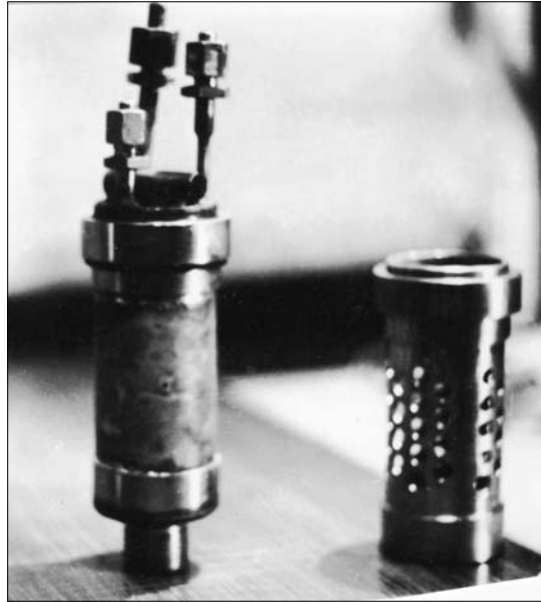
Рис. 6. Центральный элемент решетки фазоразделителей
