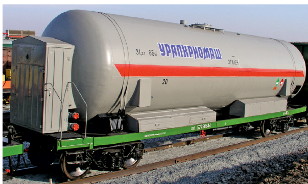
Рис. 3. Вагон-цистерна модели 15-147У для транспортировки этилена и СПГ
