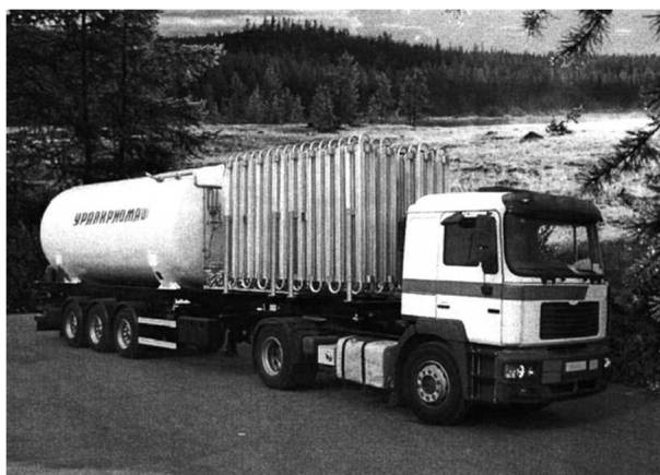
Рис. 10. Криогенный транспортный комплекс контейнер-цистерна и газификатор
