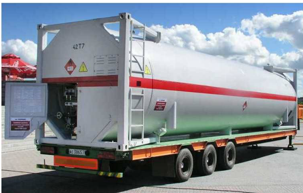
Рис. 6. Контейнер-цистерна модели КЦМ-35/06 для транспортировки СПГ
