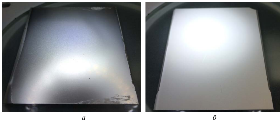
Рис. 3. Изображение оловянной пленки, осажденной на подложки AlN с использованием вращения: а — полированный AlN; б — шлифованный AlN
