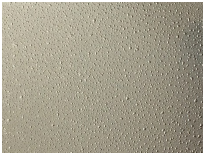
Рис. 1. Изображение поверхности оловянной пленки при реализации процесса с добавлением потока газа без перехода в режим самораспыления и без вращения подложек (увеличение 2×)
