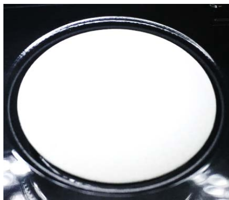
Рис. 4. Изображение оловянной пленки, осажденной на теллурид висмута
