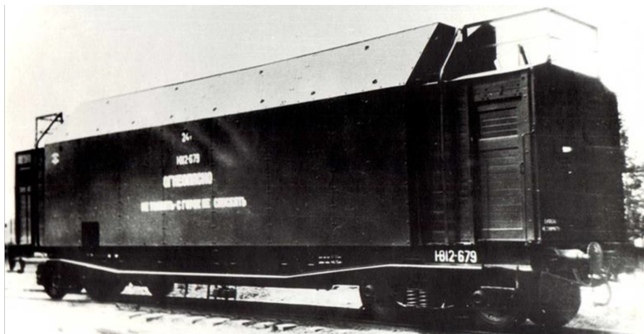
Рис. 2. Железнодорожная цистерна модели 8Г54 для транспортировки жидкого азота
