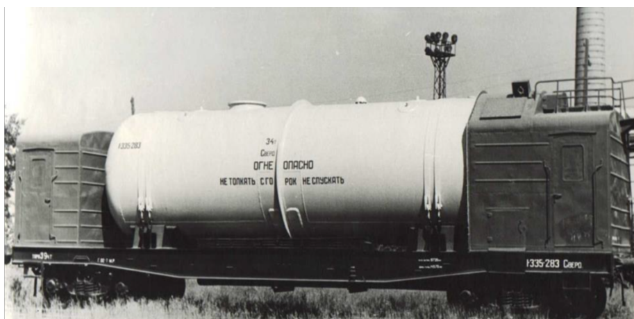
Рис. 3. Железнодорожная цистерна модели 8Г512 для транспортировки жидкого кислорода и азота
