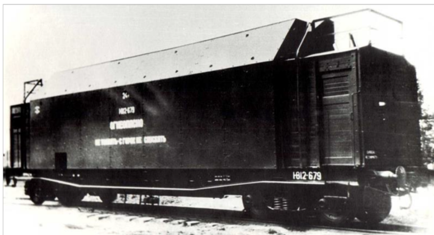
Рис. 1. Железнодорожная цистерна модели 8Г52 для транспортировки жидкого кислорода
