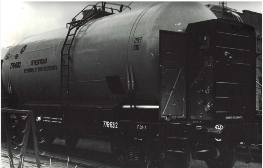
Рис. 4. Железнодорожная цистерна модели 8Г513 для транспортировки жидкого кислорода, азота, аргона
