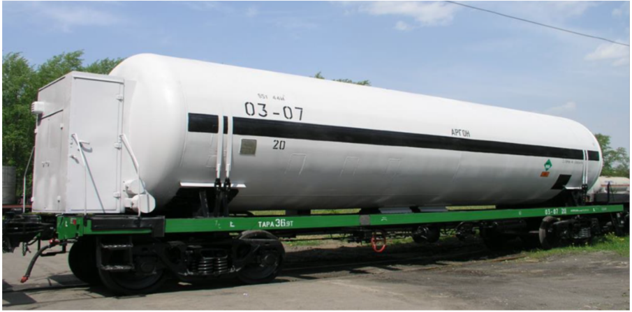
Рис. 6. Железнодорожная цистерна модели 15-558С-01 для транспортировки жидкого кислорода, азота, аргона
