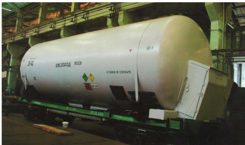
Рис. 7. Железнодорожная цистерна модели 15-558С-03 для транспортировки жидкого кислорода, азота, аргона
