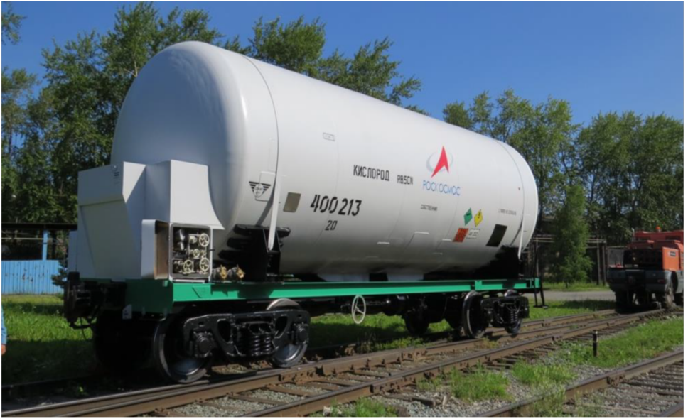
Рис. 8. Железнодорожная цистерна модели 15-558С-04 для транспортировки жидкого кислорода, азота, аргона
