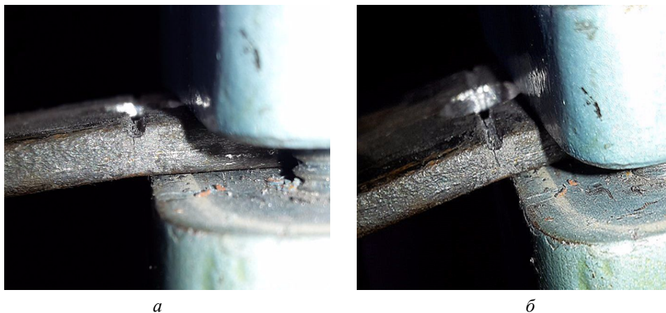
Рис. 5. Размеры трещины после 8 тыс. ( а ) и 19 тыс. ( б ) циклов нагружения
