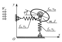
Расчетная схема в задаче исследования устойчивости положений равновесия профиля в потоке единицу длины профиля:
