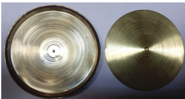
Рис. 4. Заготовка с буртом (слева) и после обработки без бурта (справа)
