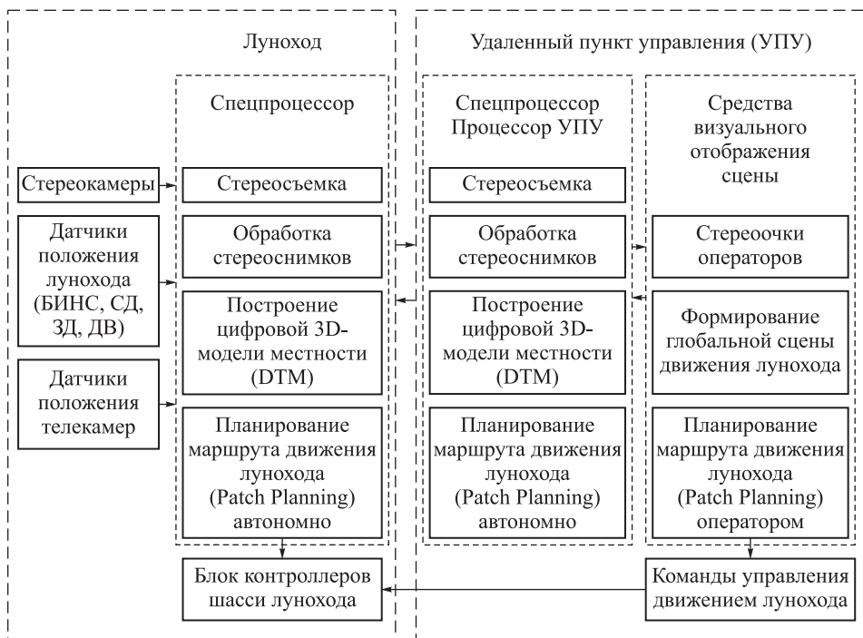
Рис. 6. Общая схема автоматического и операторного управления луноходом: датчики положения лунохода: БИНС — бесплатформенная инерциальная навигационная система; СД — солнечный датчик (в общем случае); ЗД — звездный датчик; ДВ — датчик вертикали
