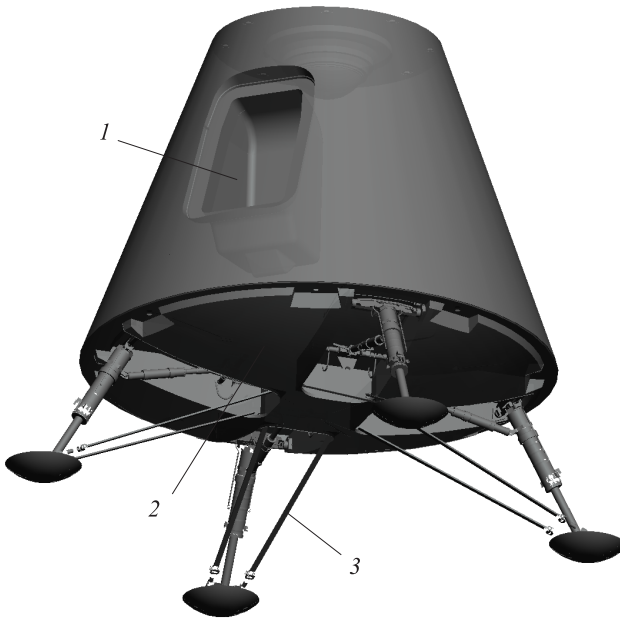
Рис. 1. Модель ВА без двигательной установки: 1 — парашютный контейнер; 2 — экран агрегатного отсека; 3 — опоры посадочного устройства
