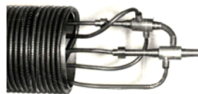
Рис. 5. Каскад вихревых труб ( d_{T_1} = 3,5 \text{ мм} , d_{T_2} = 5,0 \text{ мм} )
