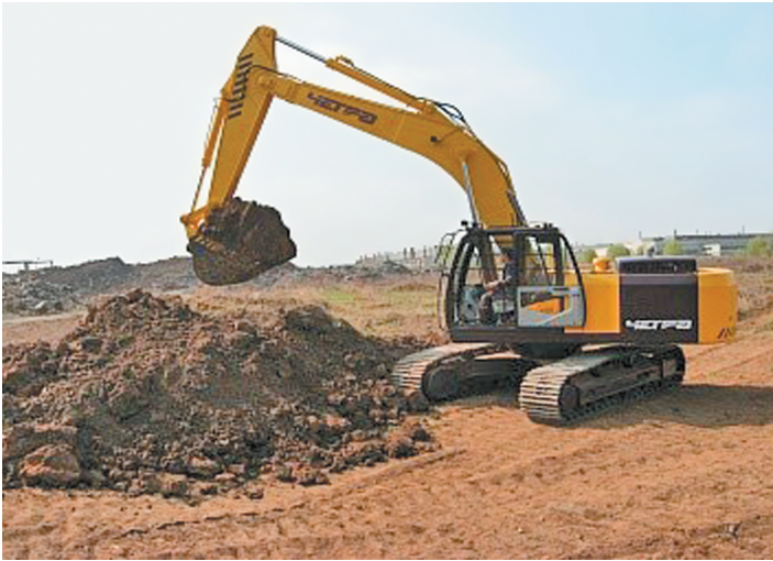
Рис. 1. Гусеничный экскаватор ЧЕТРА ЭГП-230
