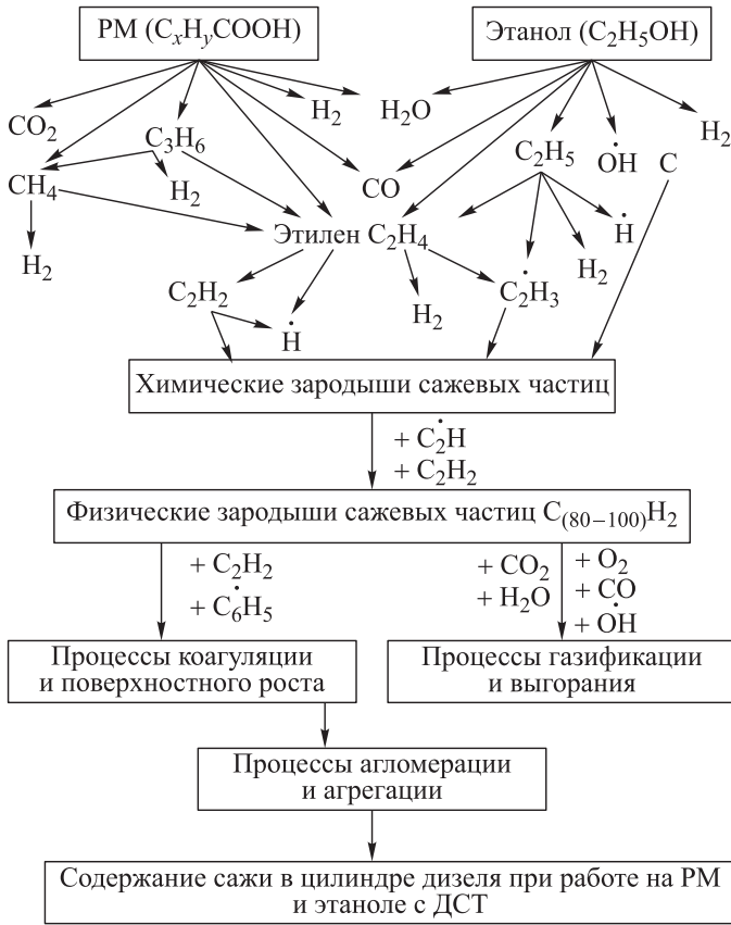
Рис. 1. Химизм сажеобразования при работе дизеля на этаноле с использованием ДСТ с воспламенением от запальной струи РМ
