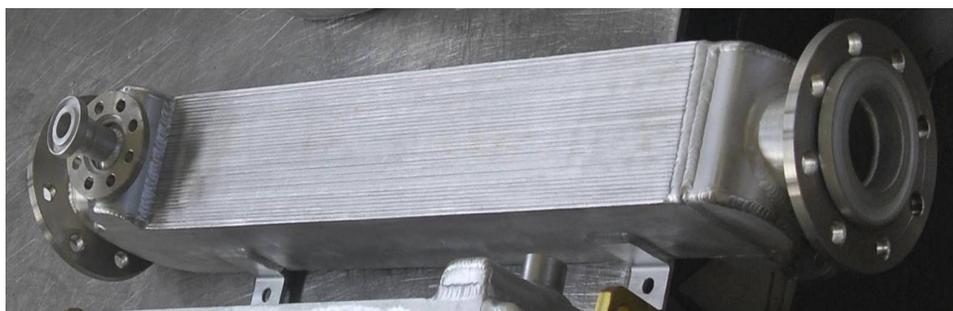
Рис. 16. Теплообменный аппарат нагрузки АТ<sub>н</sub>. Общий вид
