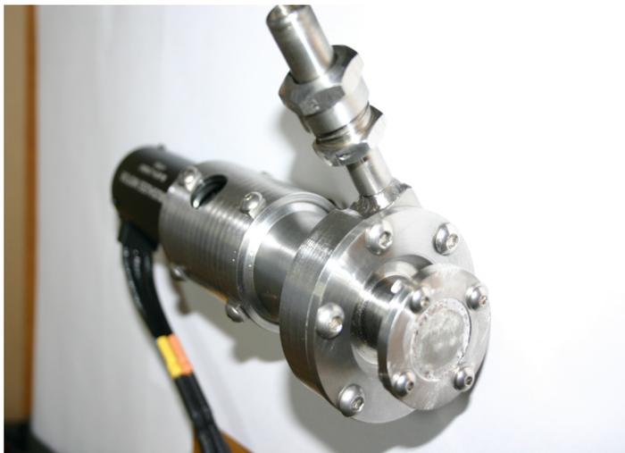
**Рис. 4.** Насос АКН-017 с электроприводом. Общий вид
