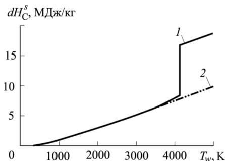
**Рис. 1.** Зависимость приращения энтальпии конденсированного углерода от температуры:
