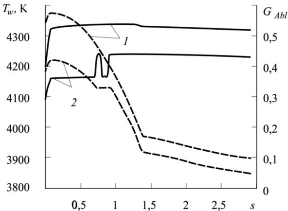
**Рис. 2.** Распределение квазистационарных параметров абляции углеродного материала на поверхности затупленного конуса в рамках метода работ [3, 4] в зависимости от криволинейной координаты, отсчитываемой вдоль образующей конуса в долях от радиуса его сферического затупления:
