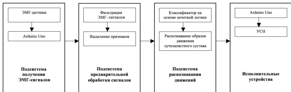
Рис. 4. Блок-схема процесса сбора и обработки данных ЭМГ
