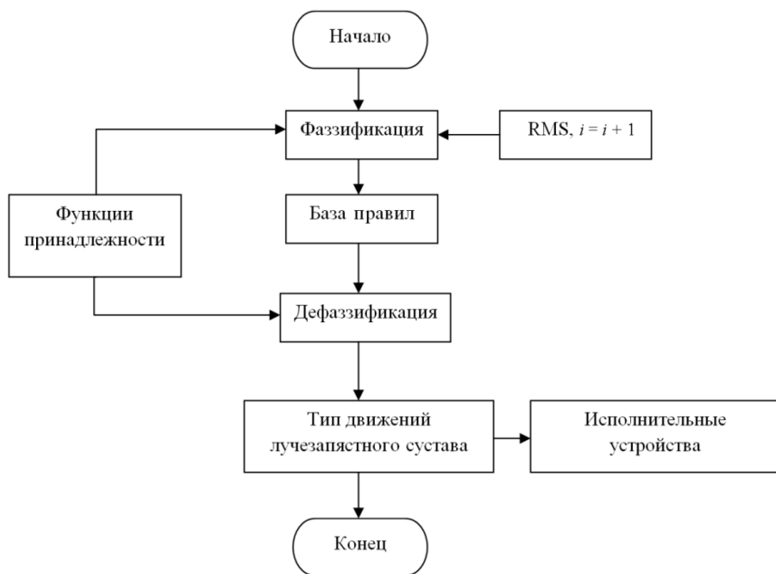
Рис. 5. Алгоритм функционирования подсистемы распознавания типа движения лучезапястного сустава
