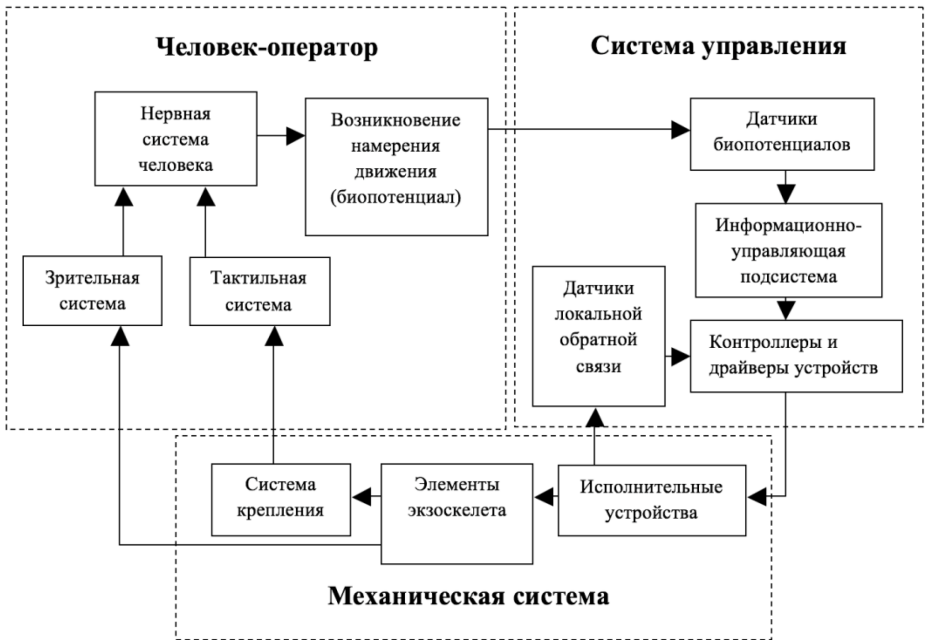
Рис. 1. Функциональная модель экзоскелетного устройства
