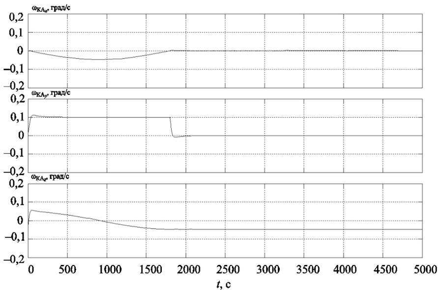
Рис. 6. Графики изменения угловых скоростей КА в режиме ОГК с программным поворотом
