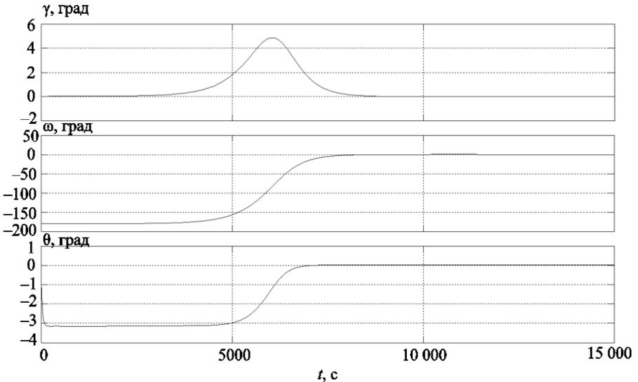
Рис. 2. Графики изменения углов КА в режиме «классического» ОГК:
