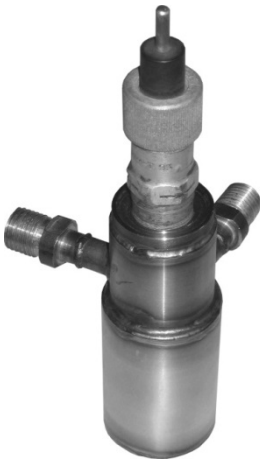
Рис. 13. Стендовый образец камеры РДМТ со стороны узла воспламенения
