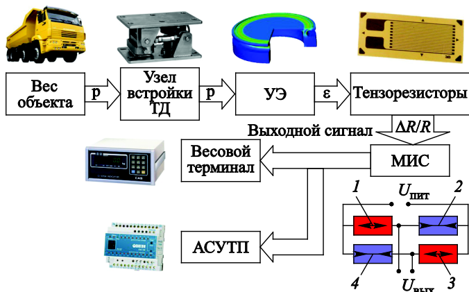
Рис. 1. Цепь преобразования физических величин при измерении веса ТД (1 и 3 — номера плеч МИС, работающих на растяжение, 2, 4 — на сжатие)
