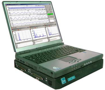
Рис. 5. Измерительно-вычислительный комплекс МИС-200
