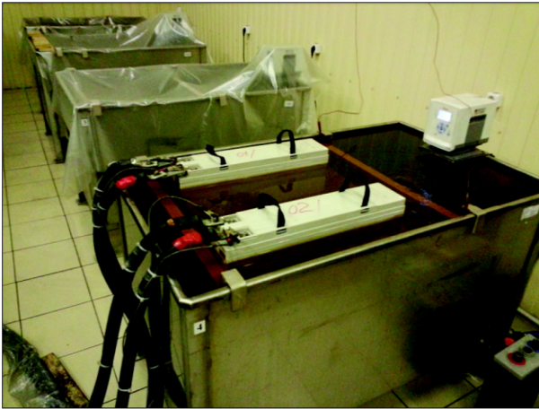
Рис. 1. Размещение технологического оборудования в открытом резервуаре с нагретой водой при проведении тепловых испытаний
