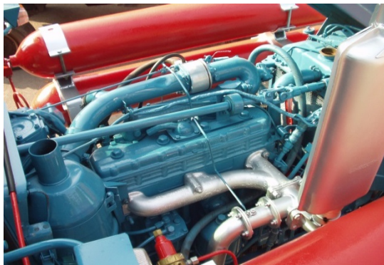
Рис. 9. Система питания на сжатом природном газе с рециркуляцией отработавших газов для двигателя, установленного на тракторе
