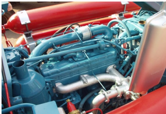
Рис. 9. Система питания на сжатом природном газе с рециркуляцией отработавших газов для двигателя, установленного на тракторе
