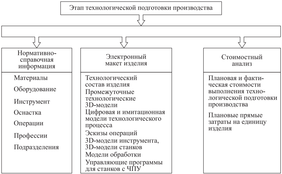
Рис. 2. Сегмент структуры информационного пространства этапа технологической подготовки производства
