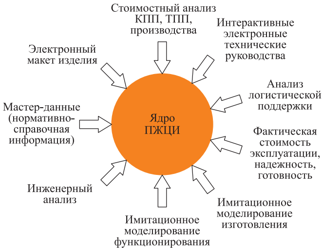
Рис. 2. Структура информационного пространства ПЖЦИ: КПП — конструкторская подготовка производства; ТПП — технологическая подготовка производства
