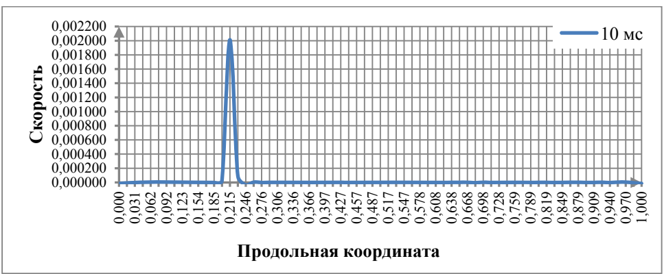
Рис. 7. График распределения компоненты вектора скорости \bar{v}_3(\tilde{x}_3) (м/с) в пластине из тканевого композита при фильтрации в ней жидкого связующего для случая наличия перепада внешнего давления p_{e2} - p_{e3} = 0,01 МПа
