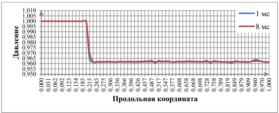
Рис. 4. График распределения порового давления \bar{p}_a(\tilde{x}_3) (атм) в пластине из тканевого композита при фильтрации в нем жидкого связующего для случая отсутствия перепада внешнего давления p_{e2} - p_{e3}
