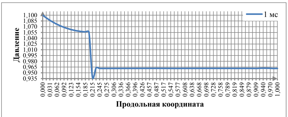
Рис. 6. График распределения порового давления \bar{p}_a(\tilde{x}_3) (атм) в пластине из тканевого композита при фильтрации в нем жидкого связующего для случая наличия перепада внешнего давления p_{e2} - p_{e3} = 0,01 МПа
