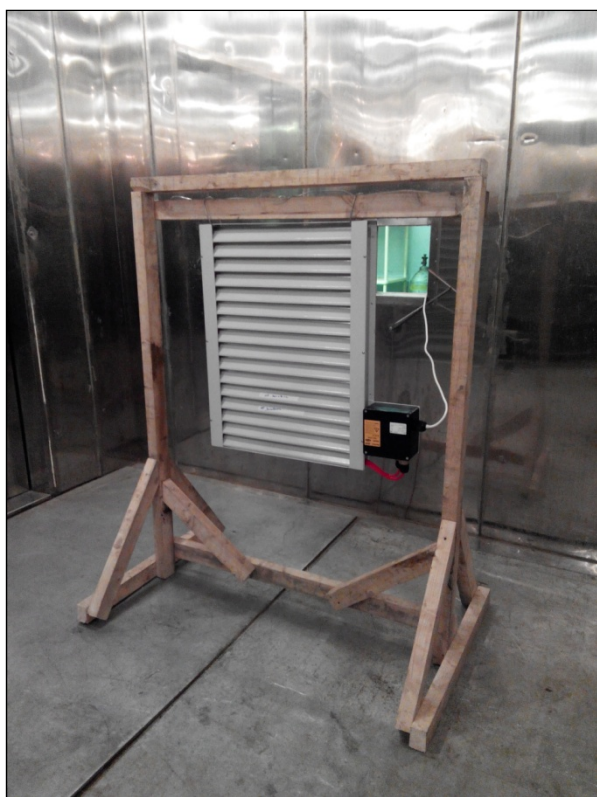
Рис. 7. Опытный образец ПСО СВР в климатотермокамере
