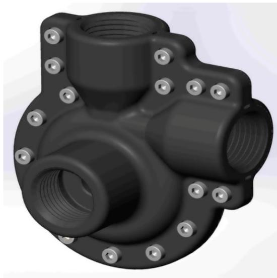
Рис. 2. Трехмерная модель вихревого регулятора
