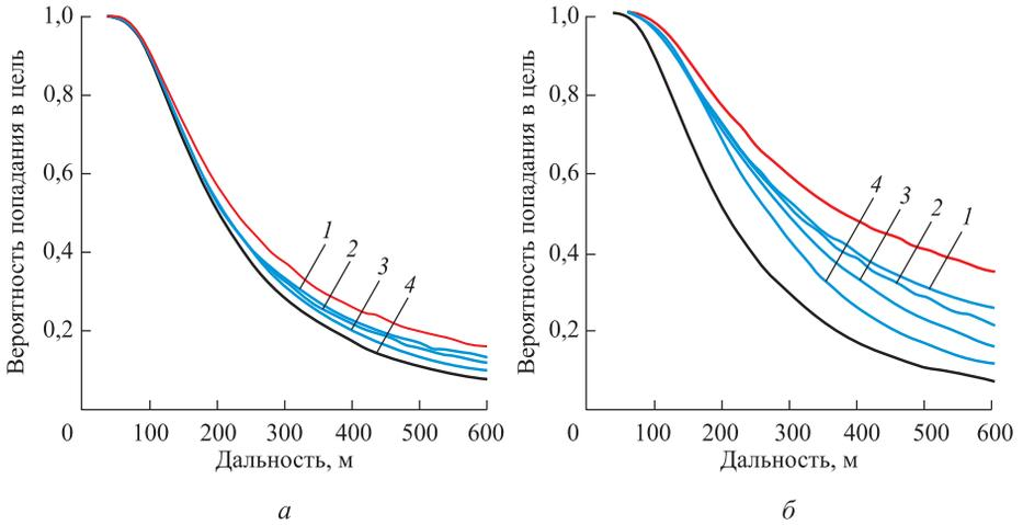
**Рис. 3.** Вероятность попадания в танк при фронтальной стрельбе (для стандартных условий стрельбы из ручного гранатомета по неподвижной цели в безветренную погоду):
