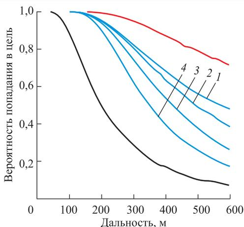
**Рис. 5.** Вероятность попадания в танк при фронтальной стрельбе (прицеливание с применением ПУО и наилучшим ручным ориентированием оружия при стандартных условиях стрельбы из ручного гранатомета по неподвижной цели в безветренную погоду): при  $E_p = 0,675$  т.д.,  $E_o = 2$  т.д., нулевой скорости ветра и нулевой скорости цели; 1 —  $dv = 0$ ; 2 —  $dv = 2$ ; 3 —  $dv = 4$ ; 4 —  $dv = 7$
