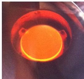
Рис. 8. Раскаленная мишень толщиной 3,75 мм при выключенном питании
