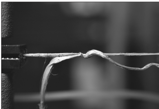
Рис. 3. Фотография образца для определения адгезии волокна к связующему методом вытягивания из петли
