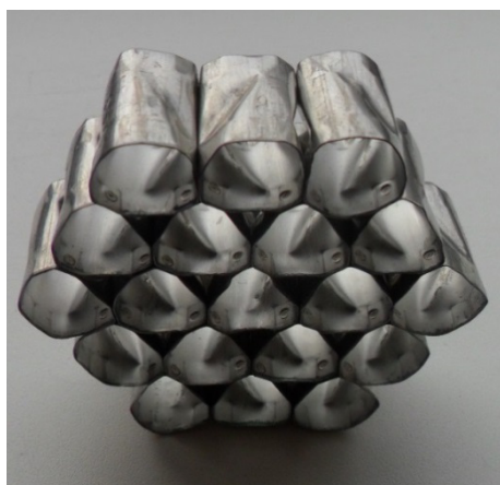
Рис. 2. Внешний вид ячеек дистанционирующей решетки с перемешивающими свойствами:
