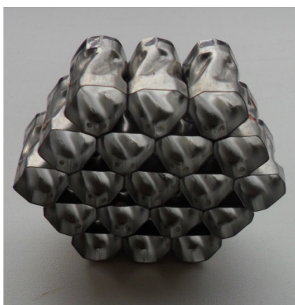
Рис. 2. Внешний вид ячеек дистанционирующей решетки с перемешивающими свойствами:
