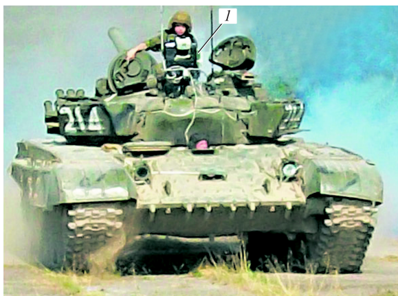
Рис. 8. Система автономного управления движением РТК «Алиса»: 1 — кронштейн с модулями СТЗ и навигации
