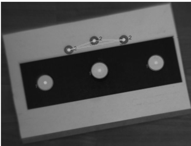
Рис. 12. Пример ошибочного выбора треугольника центров реперов
