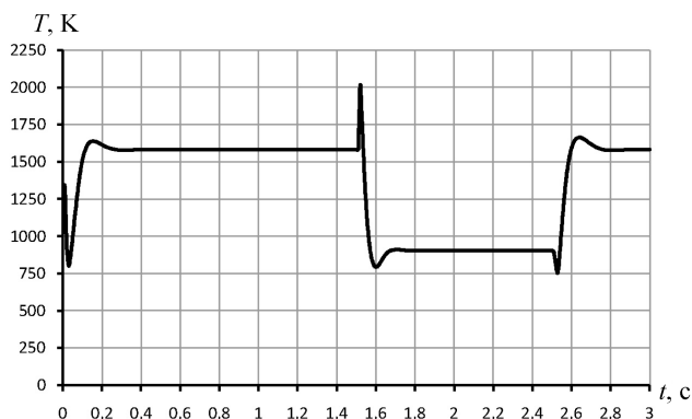
Рис. 4. График изменения температуры в камере дожигания
