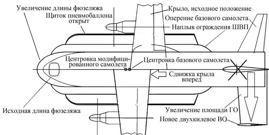
**Рис. 4.** Совмещение видов в плане базового и модифицированного вариантов ЛТС
