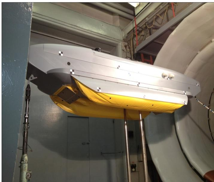
**Рис. 2.** Стенд для отработки механизма выпуска и уборки гибкого ограждения
