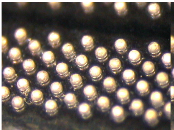
Рис. 8. Контакты полупроводниковой структуры, применяемой при сборке элементов типа chip-scale-package
