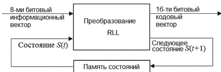
Рис. 5. Схема кодирования с помощью кодов с ограниченной длиной поля записи
