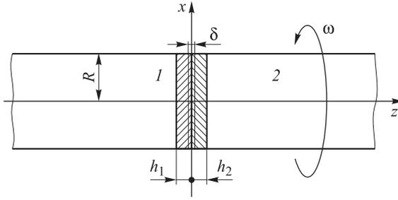
Рис. 1. Схема взаимодействия двух цилиндрических тел
