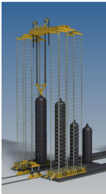
Рис. 4. Конструкция гидравлической прядевой порталной подъемной системы B-Set
