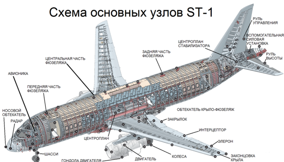
Рис. 3. Внешний вид и основные узлы ST-1 [9]
