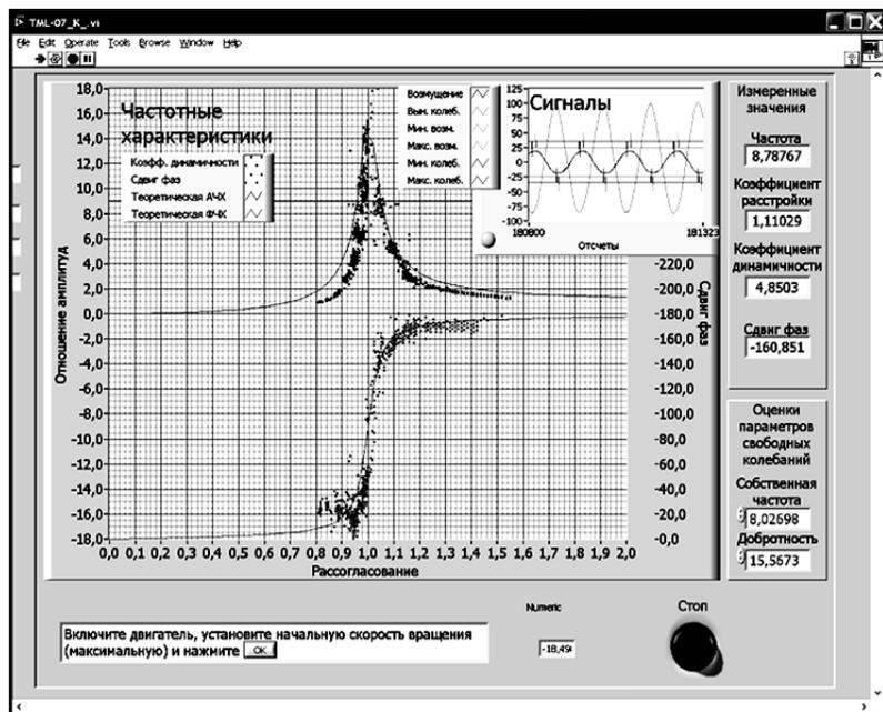
Рис. 3. АЧХ и ФЧХ на экране виртуального прибора
