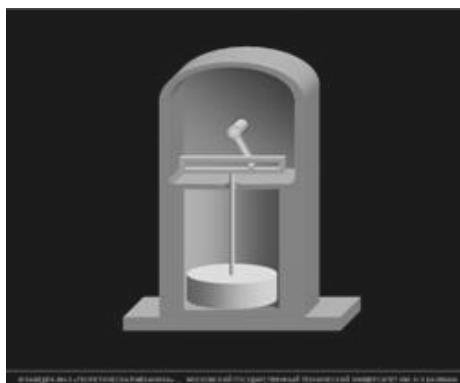
Рис. 3. Пример реализации кулисного механизма в конструкции насоса
