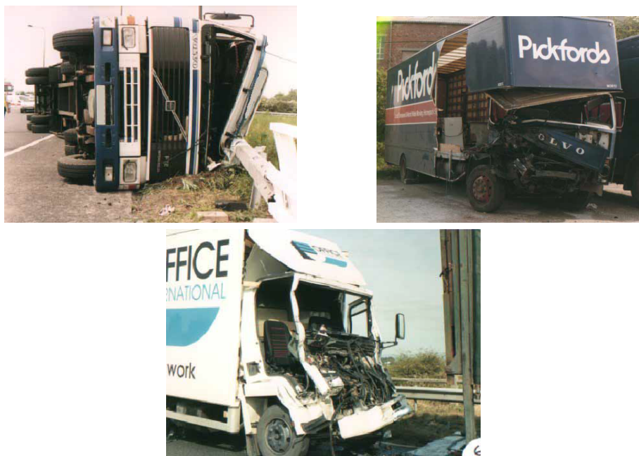
Рис. 4. Примеры деформаций кабин грузовых автомобилей после аварии
