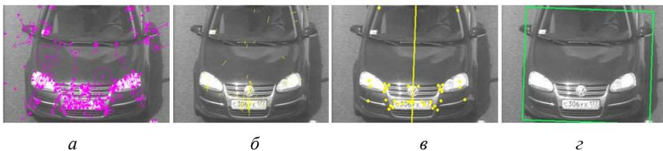
Рис. 4. Этапы определения ограничивающего прямоугольника ТС
