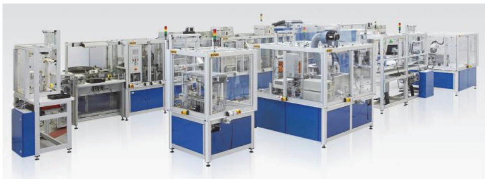
Рис. 2. Комплексная производственная линия сборки переключателей для мотоцикла на основе 3D-MID
