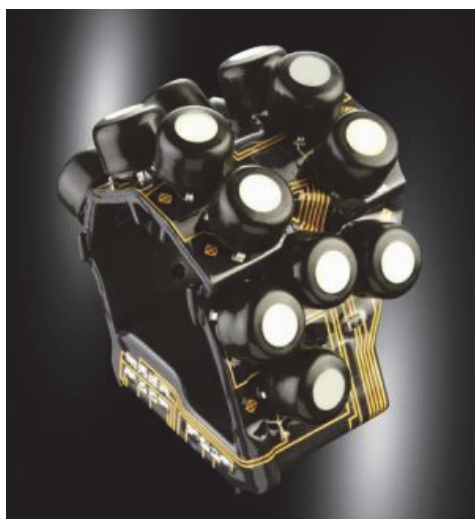
Рис. 3. Собираемое устройство 3D-MID — переключатель для мотоциклов
