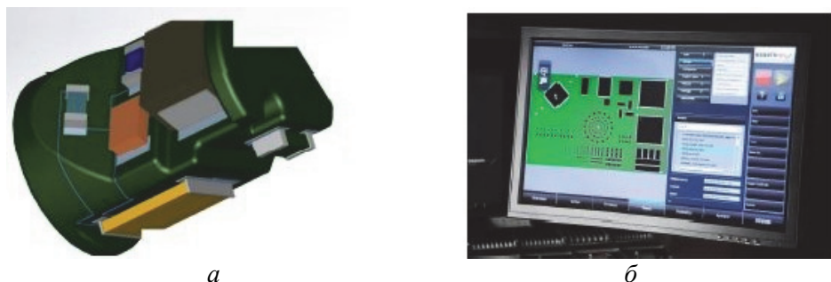
Рис. 9. Модель устройства 3D-MID в САПР NEXTRA (а) и разработанная по данным САПР управляющая программа на экране монитора автомата (б)
