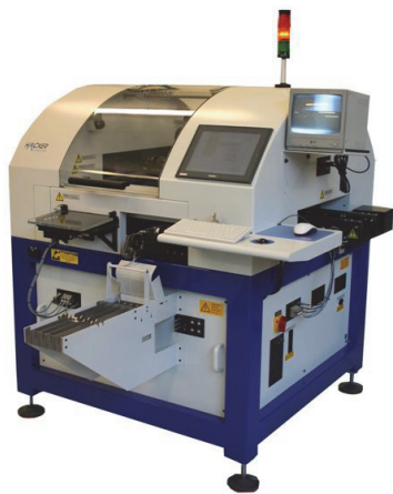
Рис. 5. Система трехмерной микросборки VICO 520 M
